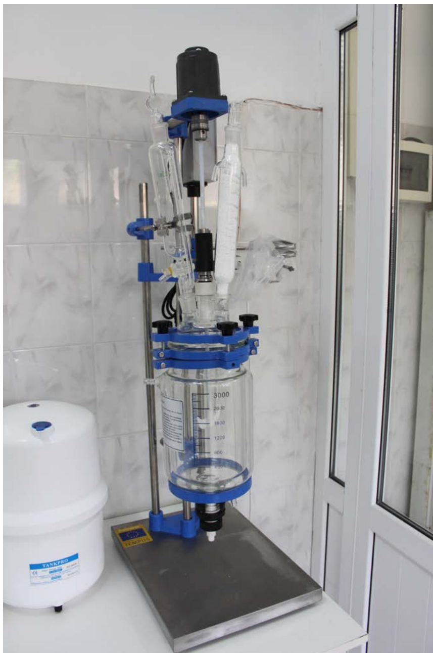
Биореактор для исследования роста клеточных и бактериальных культур.
